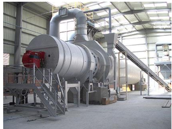
Fig. 4 Four de cuisson du gypse (Alphaplatre)
