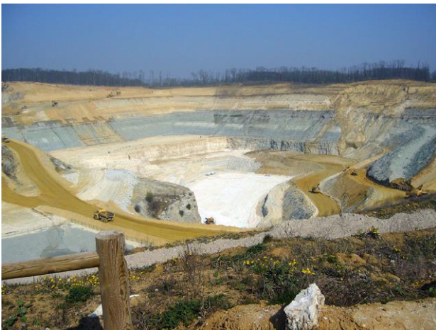
Fig. 2 Extraction du gypse à ciel ouvert
